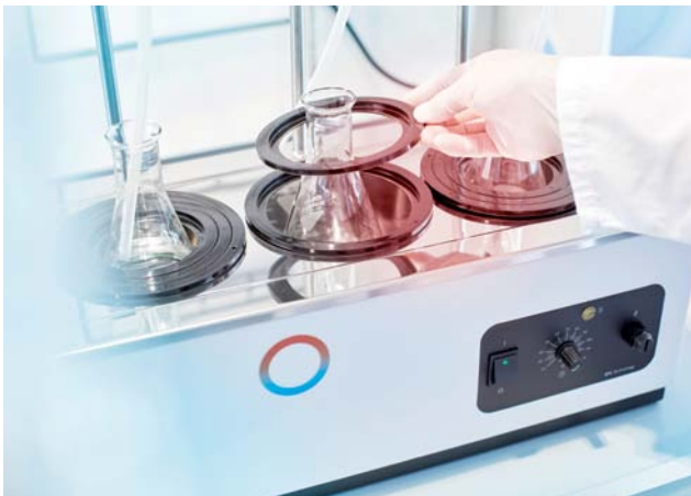
Die Lochdeckel bestehen aus einem mehrteiligen Ringsatz. Die einzelnen Ringe sind abnehmbar
